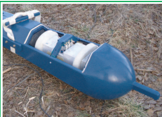
Рис. 5 Приемник, установленный в гондолу
