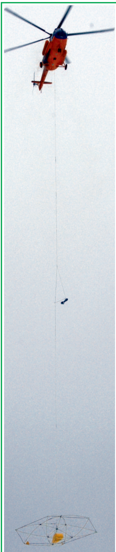
Рис. 1 Вертолетная электроразведочная система «Экватор»
