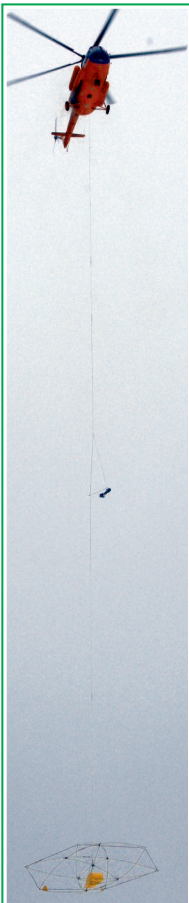
Рис. 1 Вертолетная электроразведочная система «Экватор»
